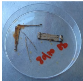
Fibre corrodibili, prova non superata
