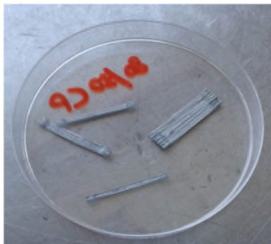
Fibre anticorrosione, prova superata
