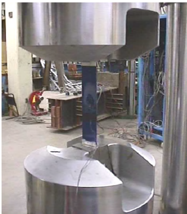
Esecuzione del test secondo ASTM D3039
